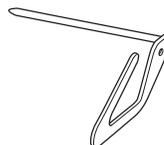
**1** Insérez la tige du guide ouateur dans l'orifice se trouvant à l'arrière du support de pied-de-biche ou du pied à double entraînement.
