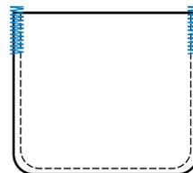
**1** Déterminez la longueur souhaitée du point d'arrêt. Réglez la plaque du guide-bouton du pied pour boutonnière "A" à la longueur voulue. (La distance entre les repères de la règle du pied-de-biche correspond à 5 mm (3/16").)
