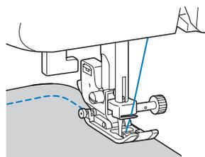
Si vous cousez le long d'une ligne courbe en utilisant un point zigzag, sélectionnez une longueur de point moindre pour obtenir un point plus fin.
