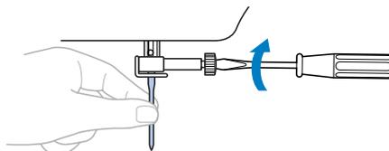
Installez l'aiguille jumelée de la même façon.
