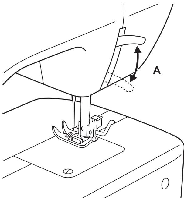
Pour faciliter l'insertion de tissus très épais sous le pied-de-biche, on peut augmenter l'espace entre le pied-de-biche et la plaque à aiguille, en relevant le levier du pied-de-biche d'un cran. (A)
