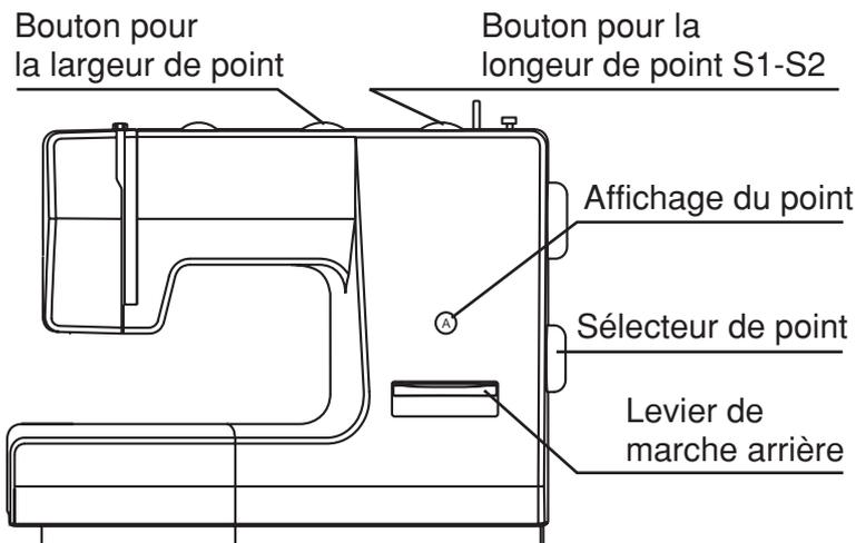
**Points droits** sélectionnez le bouton de sélection de point et tournez-le jusqu'au symbole souhaité ou jusqu'à ce que la lettre apparaisse dans la fenêtre " | ". Réglage de la position de l'aiguille à gauche ou à droite en tournant le bouton de sélection de largeur de point. Régler la longueur de point avec le bouton de sélection de point.
