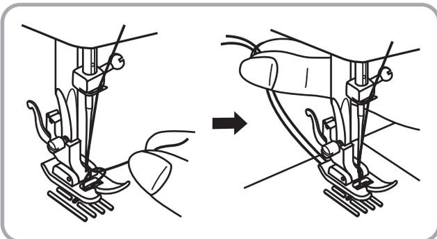
Tirez sur le fil supérieur de manière à faire remonter le fil inférieur à travers l'orifice de la plaque à aiguille. Déposez les deux fils en arrière, par-dessous le pied presseur.
