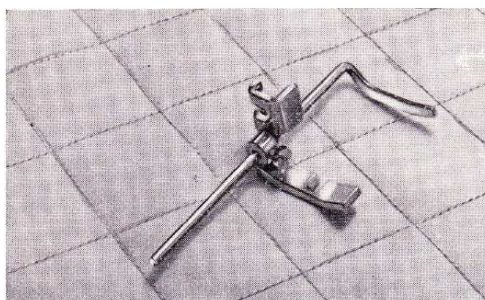
Pied pour bords avec guide pour coudre à des distances réglables (ouatiner), pour guider des bords de tissu et enrober des cordons.
