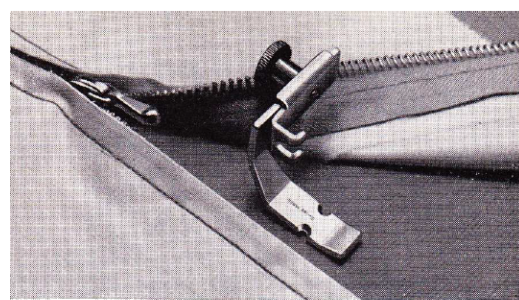
Pied réglable pour bords. Peut être déplacé à gauche et à droite de l'aiguille. Il permet la fixation de fermetures éclair et de cordons, sans devoir tourner le tissu.
